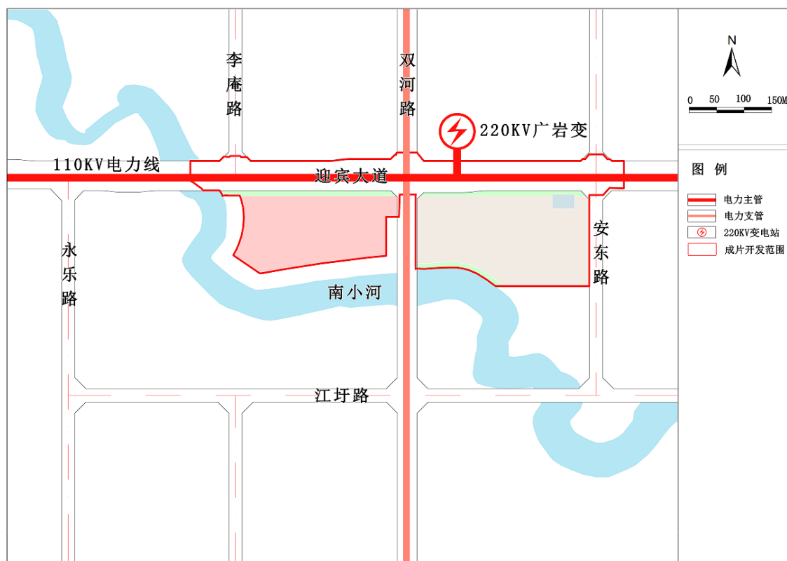
图 8 电力工程建设图
