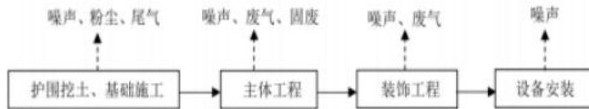
图 2-4 施工期建设流程及产污环节简图
