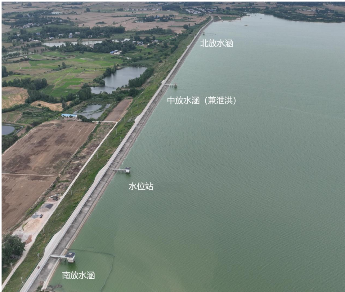
图 1.5.1 大井水库岸线工程相对位置图
