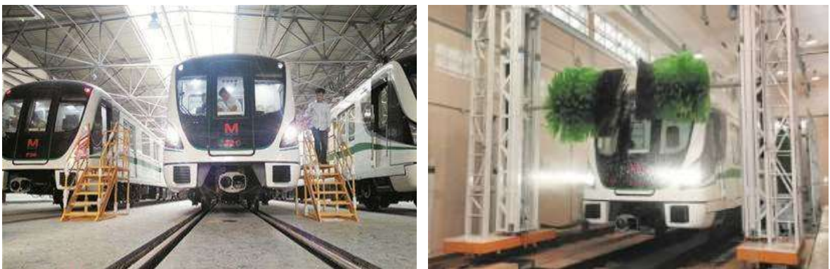
图 4.4.3-3 既有武汉地铁停车列检及洗车现场
